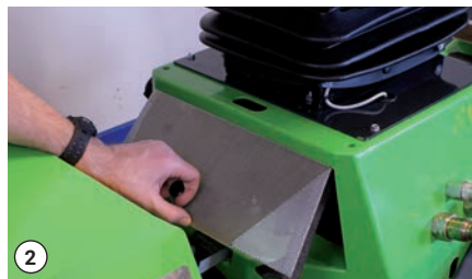
Montáž krytu olejového chladiče
