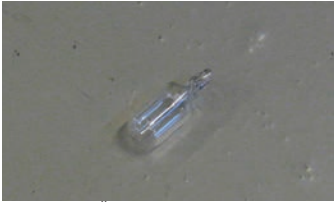
05001030 Žárovka, měřidlo nádrže
